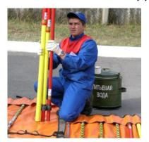
Кроме того для выполнения ремонтных работ на ВЛ 0,4 кВ с изолированным проводом командой используется **набор Жулева**, включающий весь необходимый арсенал инструментов для монтажа и ремонта провода СИП.
